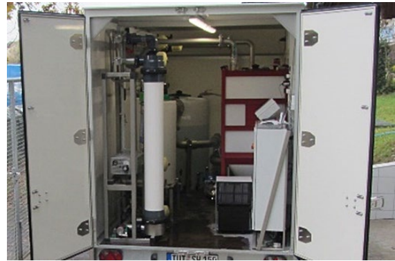
Mobile Ultrafiltrationsanlage © NOWATER-Projekt
