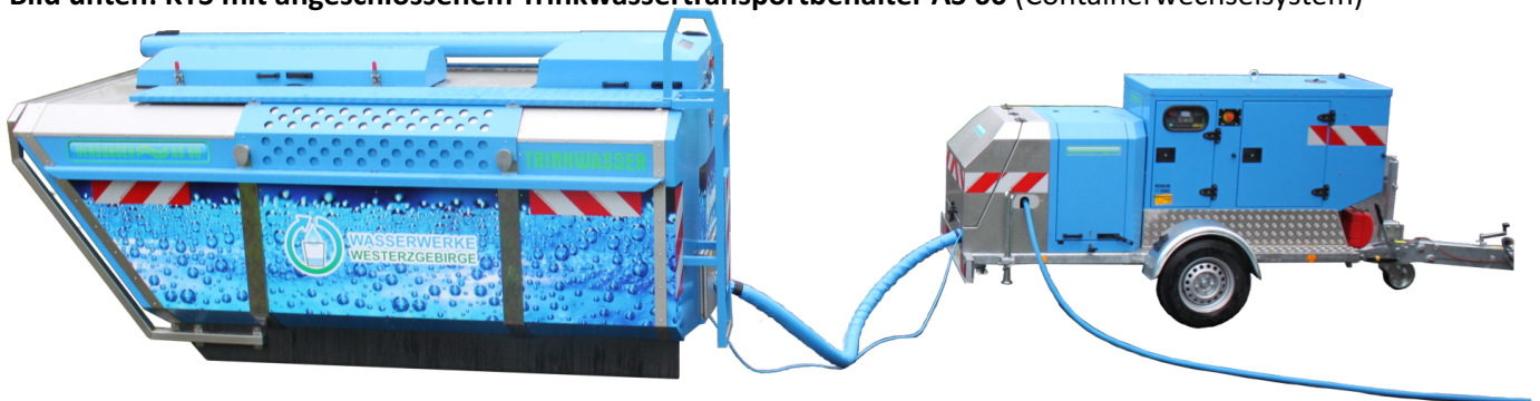
Bild unten: KTS mit angeschlossenem Trinkwassertransportbehälter AS 60 (Containerwechselsystem)
